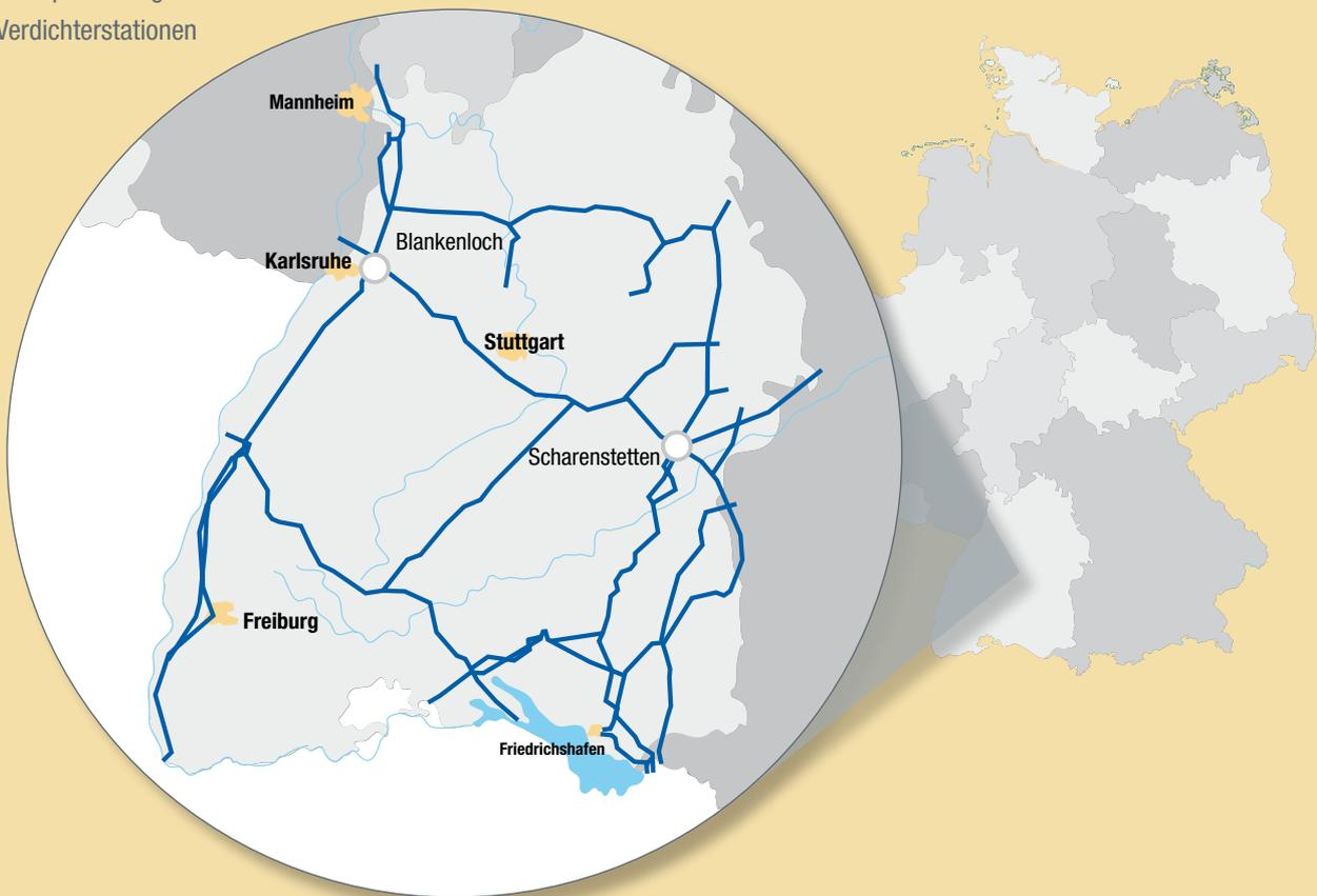
Die GVS Netz GmbH wurde zum 1. Juli 2007 gegründet und ist ein 100 %iges Tochterunternehmen der Gasversorgung Süddeutschland GmbH mit Sitz in Stuttgart. GVS Netz betreibt ein 1.923 km langes Fernleitungsnetz mit Nennweiten bis DN 700. Das Netzgebiet deckt sich weitgehend mit der Fläche Baden-Württembergs, die ca. 36.000 km<sup>2</sup> beträgt. Dem Netz der GVS sind rund 120 Gasverteilnetze nachgelagert, davon rund 50 direkt.
